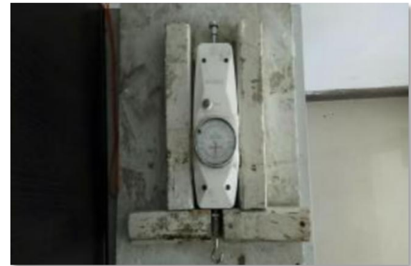
拉力测试 PULL TEST
